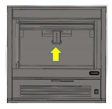
1. MAKE SURE TO INSTALL AIR TUBE AS REQUIRED. THE OPENING ON THE TUBE END NEEDS TO BE AGAINST THE BACK WALL. ALL ROUND EXIT HOLES MUST BE POINTING TO THE BOTTOM OF THE FIRE BOX OR THE SIDE WALLS.
