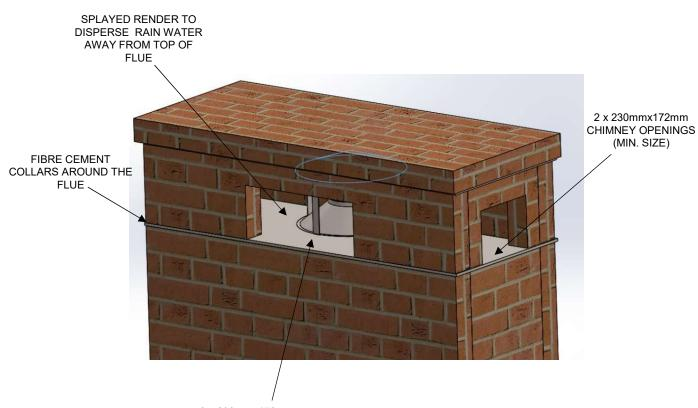
2 x 230mmx172mm CHIMNEY OPENINGS (MIN. SIZE) NOTE: IF CHIMNEY IS MORE THAN 950mm WIDE ,THEN THE TWO OUTLETS ONLY ARE QUITE PRACTICAL ON THE LONG SIDE OF CHIMNEY – WIDTH OF OUTLET TO BE WIDENED IN ACCORDANCE WITH THE LENGTH OF THE CHIMNEY
