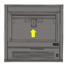
1. MAKE SURE TO INSTALL AIR TUBE AS REQUIRED. THE OPENING ON THE TUBE END NEEDS TO BE AGAINST THE BACK WALL. ALL ROUND EXIT HOLES MUST BE POINTING TO THE BOTTOM OF THE FIRE BOX OR THE SIDE WALLS.
