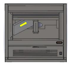
2. CERAMIC BAFFLE PLATES SIZE 230mmX240mm. INSTALL THE BAFFLE PLATE 230mm FRONT TO BACK, 240mm SIDE TO SIDE. GET BAFFLE PLATE INSIDE THE FIREBOX AND TILT ON AN ANGLE. PUSH BAFFLE PLATE OVER THE AIR TUBE
