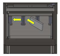
2. CERAMIC BAFFLE PLATES SIZE 205mmX340mm. INSTALL THE BAFFLE PLATE 340mm FRONT TO BACK, 205mm SIDE TO SIDE. GET BAFFLE PLATE INSIDE THE FIREBOX AND TILT ON AN ANGLE. PUSH BAFFLE PLATE OVER THE MIDDLE AIR TUBE UNTIL IT IS TOUCHING THE SIDE WALL
