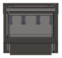
1. MAKE SURE TO INSTALL AIR TUBE AS REQUIRED. THE OPENING ON THE TUBE END NEEDS TO BE AGAINST THE BACK WALL. THE 2 MIDDLE AIR TUBES EXIT HOLES MUST BE POINTING TO THE BOTTOM OF THE FIRE BOX AND THE SIDE WALLS. THE 2 SIDE AIR TUBE HOLES NEEDS TO POINT TOWARDS THE CENTRE OF THE APPLIANCE
