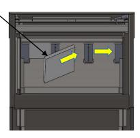
4. AGAIN REPEAT STEP 2 PROCESS BUT THIS TIME TILT THE BAFFLE PLATE THE OPPOSITE WAY. THE BAFFLE PLATE WILL BE INSTALLED ON THE RIGHT HAND SIDE. PUSH ALL THE WAY TO THE SIDE AND BACK.
