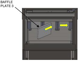
4. AGAIN REPEAT STEP 2 PROCESS BUT THIS TIME TILT THE BAFFLE PLATE THE OPPOSITE WAY. THE BAFFLE PLATE WILL BE INSTALLED ON THE RIGHT HAND SIDE. PUSH ALL THE WAY TO THE SIDE AND BACK.
